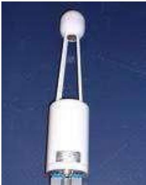
À se rappeler : Mesurer les covariances de la vapeur d'eau et de la température à l'aide de la Vitesse Verticale pour "corriger" la covariance du flux de CO2 brut en cas d'utilisation de capteurs à trajectoire ouverte.
